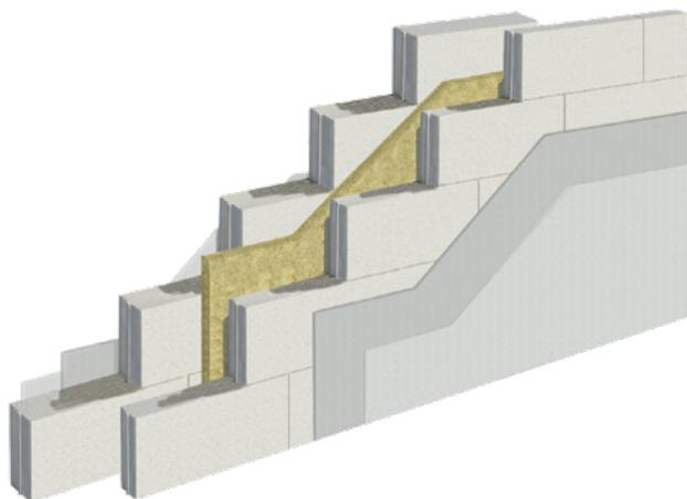
L'uso del **blocco Y-ACU ad alta densità**, unito al blocco classico Ytong Y-PRO, permette l'ulteriore vantaggio di evitare l'intonaco interno tra le murature.
