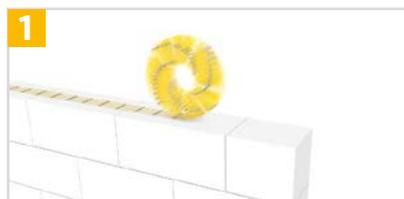
**1.** Srotolare Ytofor direttamente sui blocchi allineati e tagliarlo a misura.
