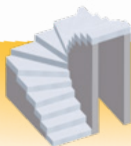
Točité dvouramenné schodiště
