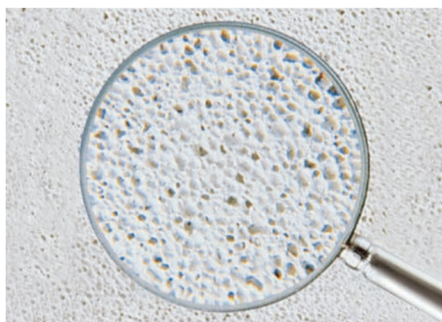
La structure cellulaire typique d'Ytong.
